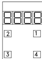
Este compacto dispone de un display de 4 dígitos y de 4 pulsadores integrados en el bloque del separador, los cuales permiten elegir y visualizar las distintas direcciones y sus contenidos.
