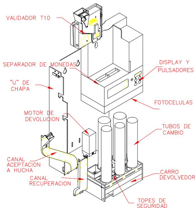
El grupo de validación J2000 es un sistema integrado de validador electrónico de monedas y devolución para máquinas de venta automática con protocolo Ejecutivo o MDB. Dispone de un validador electrónico de monedas modelo T10, un separador de 5 vías y de 5 tubos devolvedores, lo que proporciona una gran cantidad de cambio.
